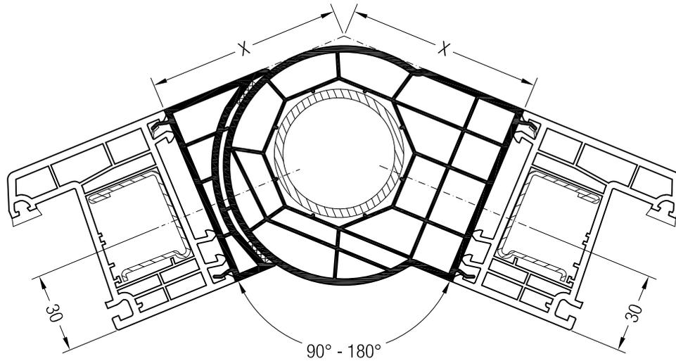
Bitte beachten Sie: Bei verstellbaren Verbindungspfosten bestimmt der Winkel des Pfostens die Maße für "X" - in der nachstehenden Tabelle finden Sie eine Übersicht über die Maße von "X" in Abhängigkeit vom Winkel.
